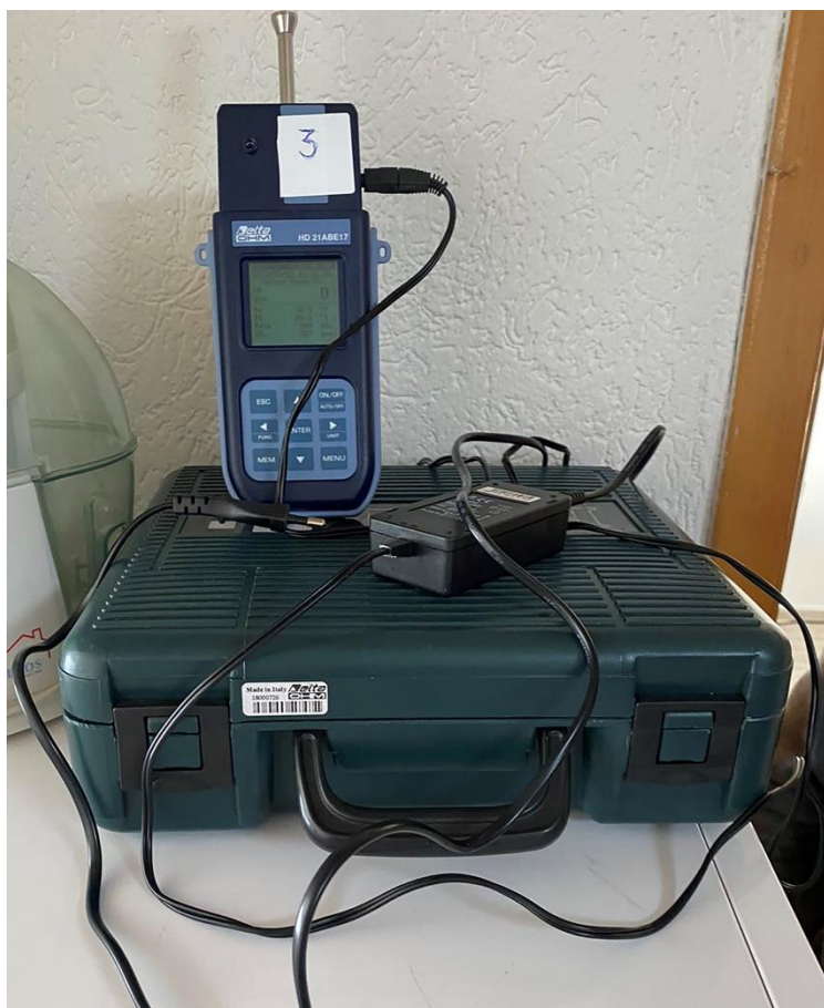
Fig. 8 Instrumenti portativ për matjen e CO 2 , CO, T dhe LR
